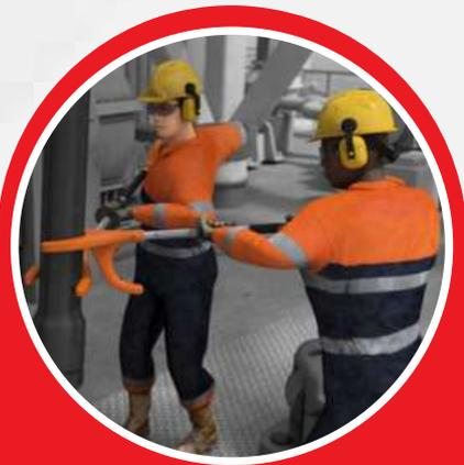
Proporciona un control excepcional de la carga y libertad del operario en la guía y ubicación de tuberías hasta 5-7/8" de diámetro.
